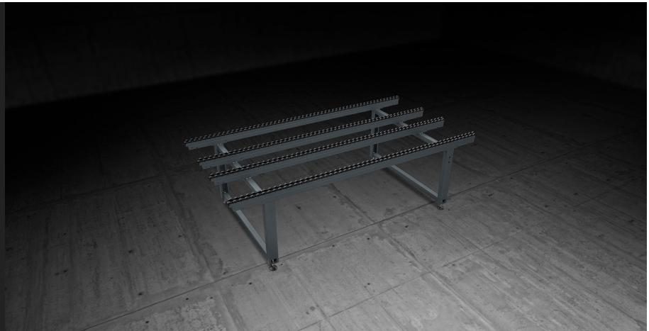
Piano a rulli che consente di unire le postazioni di assemblaggio e di trasferire cornici anche molto pesanti con estrema facilità.
