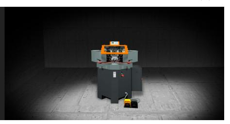
La macchina ha due teste operatrici particolari equipaggiate con masse in cui i 2 coltelli sono regolabili su tutte le posizioni di cianfrinatura. I coltelli si spostano e sono regolabili sull'asse Y (lungo il profilato), sull'asse Z (alto-basso) e sull'asse X (lungo la direzione di cianfrinatura). Queste condizioni evitano la sostituzione sulla macchina degli utensili indipendentemente dai diversi tipi di profilato. Si riducono, così, i tempi ed i costi di piazzamento.
