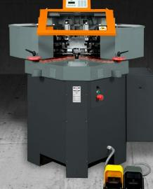
La macchina ha due teste operatrici particolari equipaggiate con masse in cui i 2 coltelli sono regolabili su tutte le posizioni di cianfrinatura. I coltelli si spostano e sono regolabili sull'asse Y (lungo il profilato), sull'asse Z (alto-basso) e sull'asse X (lungo la direzione di cianfrinatura). Queste condizioni evitano la sostituzione sulla macchina degli utensili indipendentemente dai diversi tipi di profilato. Si riducono, così, i tempi ed i costi di piazzamento.
