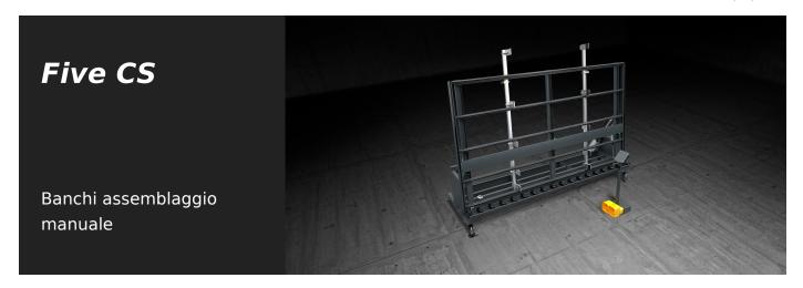
Banco di collaudo per serramenti in alluminio. Consente di ricreare le condizioni di utilizzo del serramento: il telaio è bloccato mediante sistema di morse regolabili su tutta l'altezza del serramento, si inseriscono le ante all'interno del telaio, si esegue la vetratura e il collaudo finale. La rulliera consente all'operatore il carico e lo scarico di serramenti pesanti in completa autonomia.
