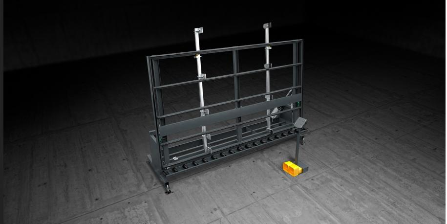
Banco di collaudo per serramenti in alluminio. Consente di ricreare le condizioni di utilizzo del serramento: il telaio è bloccato mediante sistema di morse regolabili su tutta l'altezza del serramento, si inseriscono le ante all'interno del telaio, si esegue la vetratura e il collaudo finale. La rulliera consente all'operatore il carico e lo scarico di serramenti pesanti in completa autonomia.
