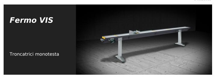
Sistema di riscontro della misura e supporto profilo con posizionamento del fermo di battuta mediante volantino e lettura della quota su display digitale.
