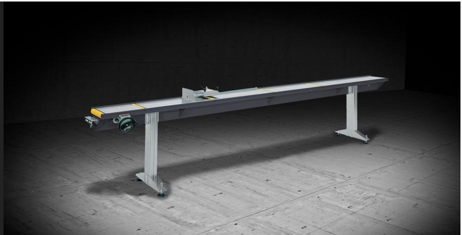
Sistema di riscontro della misura e supporto profilo con posizionamento del fermo di battuta mediante volantino e lettura della quota su display digitale.
