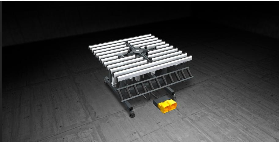
Banco per l'assemblaggio di ante con vetro con piano di lavoro inclinabile da 0° (orizzontale) a 85°. La rulliera a scomparsa è regolabile in altezza (da 170 a 460 mm) indipendentemente dal piano di lavoro. Il piano di lavoro è regolabile da 895 a 965 mm e i piedini sono provvisti di fori per il fissaggio a terra. Viene corredato di una crociera centrale per il sollevamento ed il posizionamento del vetro.
