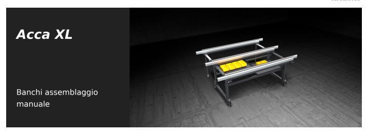
Banco idoneo a tutte le operazioni di assemblaggio dei serramenti. I piani scorrevoli ed estensibili permettono di lavorare cornici di tutte le dimensioni e strutture molto grandi in assoluta sicurezza.
