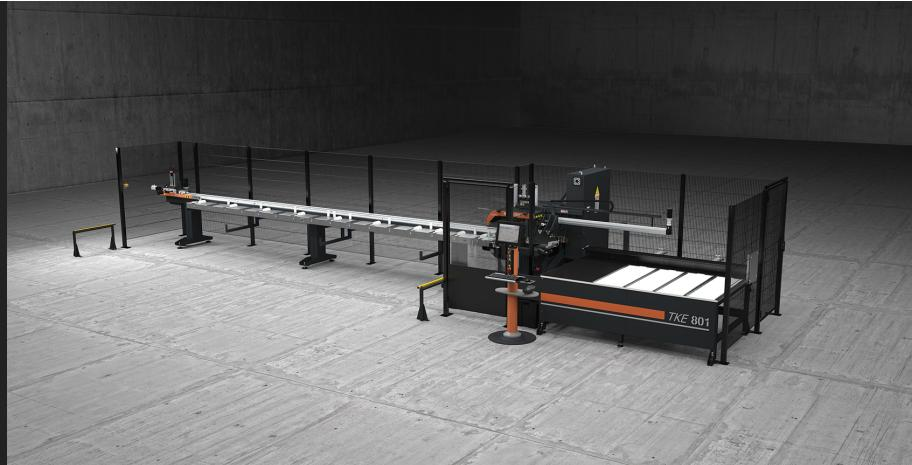
自动版本的切割中心有 3 个控制轴、相对一侧有手动装料装置和自动卸料仓、正面数控刀片专门用于切割铝、PVC 和一般轻合金型材、能够自动进行预设定、优化的切割清单。在型材的两个断面可以进行倒角切割。设计用于在 45° 至 135° 或 22°30' 至 157°30' 的角度范围内进行切割。可以与垂直或水平钻孔单元配套、来进行特殊自动加工。
