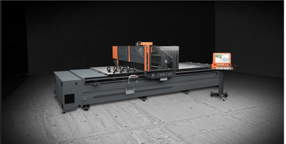
带有 3 个控制轴的数控加工中心、Y 轴上具有较大的加工能力（2000 毫米）、夹持系统由透气台面组成、可对面板和板材进行真空夹持；在加工厚度较小的部件时、这种解决方案特别有效、因为传统的虎钳系统难以夹持这类部件。加工中心配备了一系列的阀门、可以激活或关闭工作台的不同区域、并将吸力集中在某一特定区域、从而优化小尺寸元件的夹持。可以对复合板、铝、钢、不锈钢面板和板材、以及铝型材进行插补钻铣加工。
