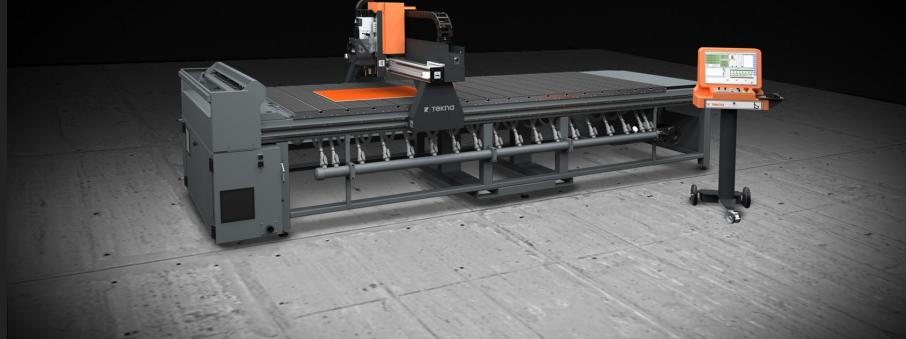
带有 3 个控制轴的数控加工中心，夹持系统由透气台面组成，可对面板和板材进行真空夹持；在加工厚度较小的部件时，这种解决方案特别有效，因为传统的虎钳系统难以夹持这类部件。加工中心配备了一系列的阀门，可以激活或关闭工作台的不同区域，并将吸力集中在某一特定区域，从而优化小尺寸元件的夹持。可以对复合板、铝和钢面板和板材进行插补钻铣加工。为生成机床引导程序，Tekna 提供了一些用户友好型软件，无论是专业数控程序员，还是完全没有经验的人都可以使用；只需几个小时的教学，客户就可以通过图形编程获得使用加工中心的必要知识。Tekna 提出的软件解决方案以客户的实际需要为基础，经过精心设计，保证了极高的易用性，从而减少管理的时间和成本。
