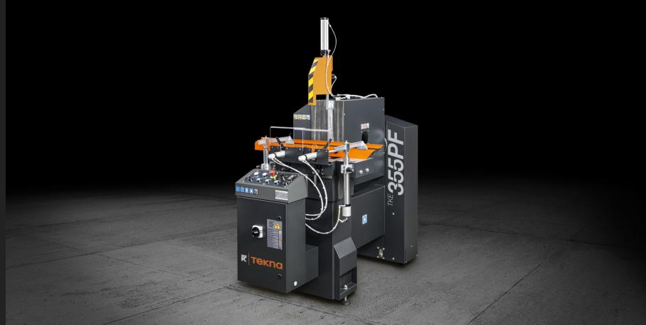
带正面刀片的单头切割机，左侧装载，气动控制的双侧翻转装置可以翻转到以下固定位置：左侧 45°和 90°，右侧 45°和 22°30'。借助一个特殊的机械止动件也可以在中间角度进行切割。
