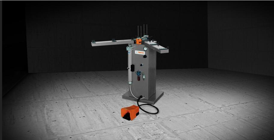
型材组装到框架上之前在型材截面上涂抹密封剂的机床。从外观角度来看、使用这种解决方案有助于大幅度提高框架的质量、防止腐蚀、并改善阻隔空气、水、噪声、冷热温度通过的性能。这款机床搭配上专用密封胶、为我们提供了一个使用方便、维护成本低的解决方案。此外、密封材料在应用上的优化、节省了大量材料、并且最大限度地减少外侧毛刺的清理需求。
