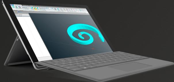
Shape是CAMplus的一个附加模块，通过这个软件，可以自由创建任何形状的图形，自由组成线条、弧线、孔洞。可以导入DXF格式的图形。由于可以三维显示，可以更好地理解具有非恒定深度的图形。通过使用Shape，原本需要通过合成“标准”图形才能实现的加工操作变得更快捷。
