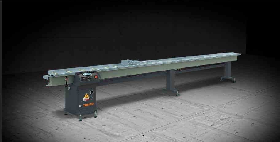
测量反馈和型材支持系统，通过直流电动机控制止动件的移动，并通过编码器进行电子读数。
