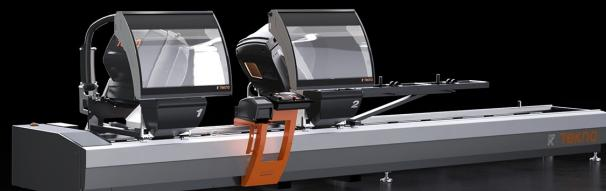
Máquina de corte de cabeça dupla de 3 eixos controlados com movimento automático da cabeça móvel e gestão eletrónica de todos os ângulos, inclusive no intervalo de 22°30' externos e 45° internos. O avanço das duas lâminas de 550 mm ocorre por meio de cilindros óleo-pneumáticos.
