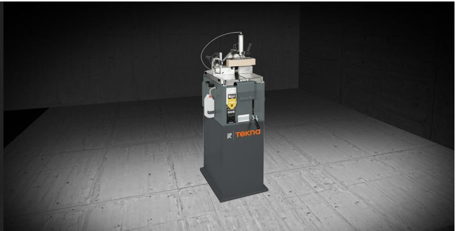
Máquina de corte monocabeça ascendente prevista para cortes a 90°, 45° à direita e à esquerda e ângulos intermediários.
