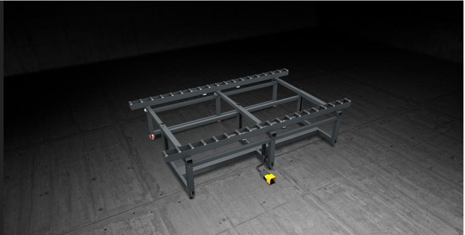
Bancada modular de grandes dimensões, dedicada à ensamblagem e à movimentação em linha de células de fachada. Está implementada com 2 pistas de roletes revestidos com uma bainha de PVC macio; a distância entre as duas pistas é regulável de acordo com a amplitude da esquadria. Um sistema por acionamento pneumático permite bloquear os roletes durante as fases de usinagem.
