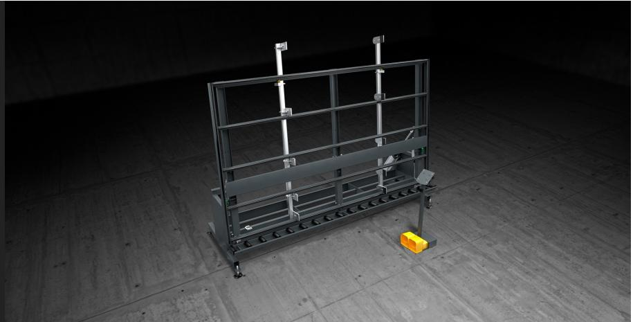
Bancada de testes de operação e desempenho para esquadrias de alumínio. Permite recriar as condições de utilização da esquadria: o marco é bloqueado mediante sistema de morsas ajustáveis em toda a altura da esquadria, se montam as folhas no interior do marco, se colocam os vidros e se realizam os testes finais de operação e desempenho. A bancada de rolos permite ao operador a carga e a descarga de esquadrias pesadas em plena autonomia.
