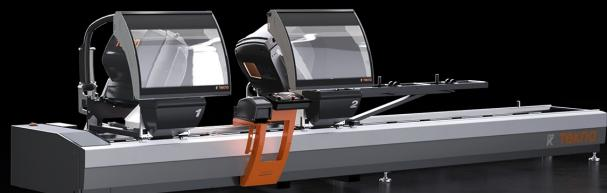
Troncatrice doppiatesta a 3 assi controllati con movimento automatico della testa mobile e gestione elettronica di tutte le angolazioni comprese nell'intervallo 22°30' esterni e 45° interni. L'avanzamento delle due lame da 550 mm avviene mediante cilindri oleo-pneumatici.
