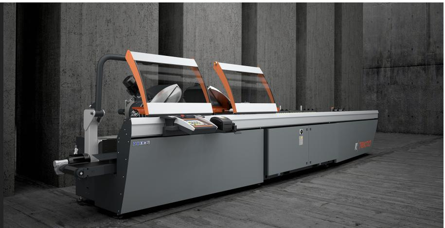
Troncatrice doppiatesta a 3 assi controllati con movimento automatico della testa mobile e gestione elettronica di tutte le angolazioni da 45° (interni) a 15° (esterni) con una precisione, all'interno di ogni grado, di 280 posizioni. L'avanzamento lama è azionato da una coppia di cilindri oleo-pneumatici.
