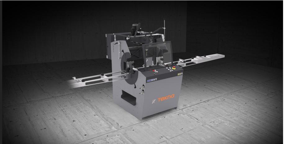
Pantografo monotesta a comando manuale con bloccaggio pneumatico e movimento di traslazione testa attraverso leva indiretta. Velocità di rotazione utensile modificabile con variatore elettronico per permettere le lavorazioni su acciaio fino a 2 mm, e per migliorare la qualità delle fresature e la durata dell'utensile. Possibilità di eseguire lavorazioni passanti su alluminio senza girare il pezzo. Piano di lavoro antigraffio. Tastatore a comando manuale.
