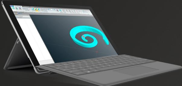
Shape, modulo aggiuntivo di CAMplus, è il software con cui è possibile creare liberamente figure di forma qualunque, componendo liberamente linee, archi, fori. E' possibile importare figure in formato DXF. Grazie alla visualizzazione in 3D permette una migliore comprensione delle figure a profondità non costante. Con Shape lavorazioni che altrimenti andrebbero ottenute componendo figure "standard", sono rese più veloci.
