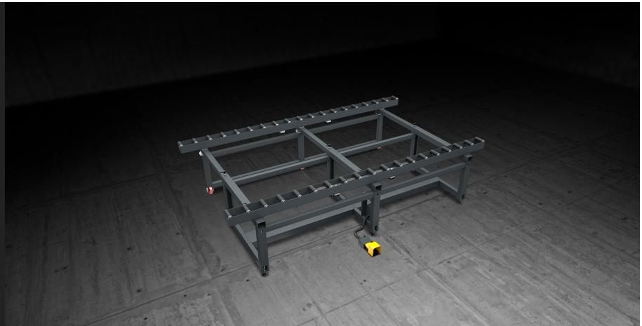
Banco modulare di grandi dimensioni dedicato all'assemblaggio ed alla movimentazione in linea di celle di facciata. È corredata di due piste di rulli ricoperti con guaina di PVC morbido; la distanza tra le due piste è regolabile manualmente in base all'ampiezza del serramento che si deve lavorare. Un sistema azionabile pneumaticamente consente di bloccare i rulli durante le fasi di lavoro.
