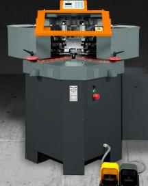
La macchina ha due teste operatrici particolari equipaggiate con masse in cui i 2 coltelli sono regolabili su tutte le posizioni di cianfrinatura. I coltelli si spostano e sono regolabili sull'asse Y (lungo il profilato), sull'asse Z (alto-basso) e sull'asse X (lungo la direzione di cianfrinatura). Queste condizioni evitano la sostituzione sulla macchina degli utensili indipendentemente dai diversi tipi di profilato. Si riducono, così, i tempi ed i costi di piazzamento.
