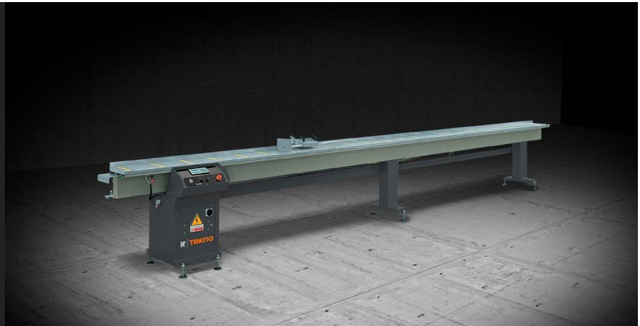
Sistema di riscontro della misura e supporto profilo con movimento del fermo mediante motore C.C. e lettura elettronica tramite encoder.
