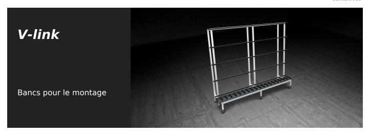
Chemin d'amenage vertical qui permet d'unir différents postes de montage et de transférer des cadres et des menuiseries, voire même particulièrement volumineux, avec beaucoup de facilité.
