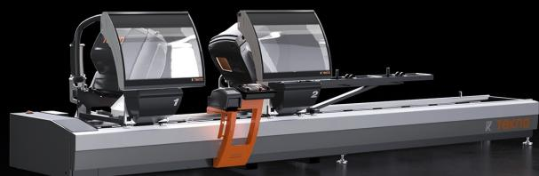
Tronçonneuse double tête à 3 axes contrôlés avec mouvement automatique de la tête mobile et gestion électronique de tous les angles dans la plage 22°30' externes et 45° internes. L'avancement des deux lames de 550 mm est assuré par des cylindres oléo-pneumatiques.
