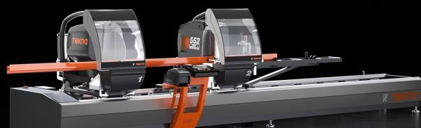
Tronçonneuse à double tête électronique, mouvement automatique de la tête mobile grâce à un moteur brushless à commande numérique par calculateur. Inclinaison pneumatique des unités de coupe de 90° jusqu'à 22°30' (externe) dans deux positions fixes ou avec système mécanique optionnel de réglage des angles intermédiaires. Avance oléopneumatique de la lame.
