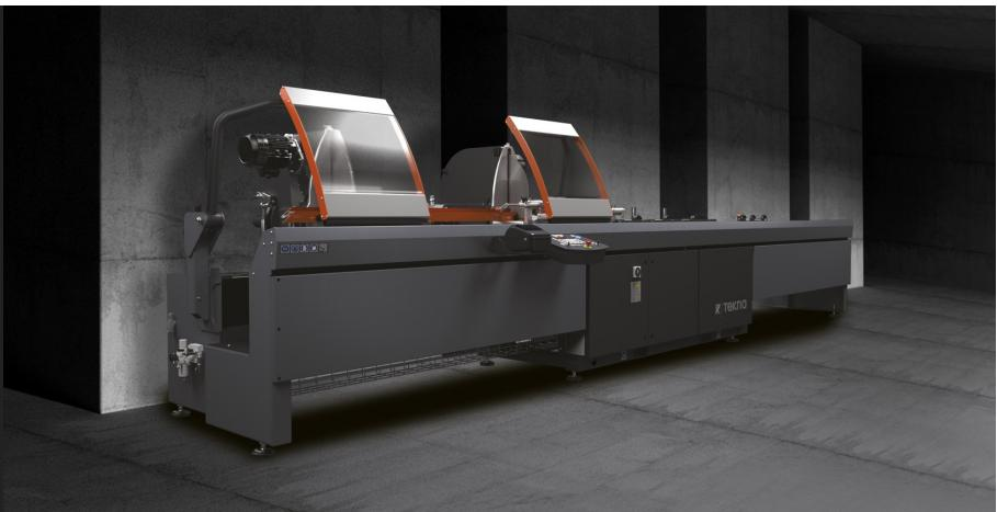
Tronçonneuse à double tête électronique, mouvement automatique de la tête mobile grâce à un moteur brushless à commande numérique par calculateur. Inclinaison pneumatique des unités de coupe à 90° jusqu'à 22°30' (externe) avec un système mécanique de réglage des angles intermédiaires. Avancement oléopneumatique de la lame.
