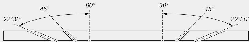
Réglage mécanique des angles intermédiaires
