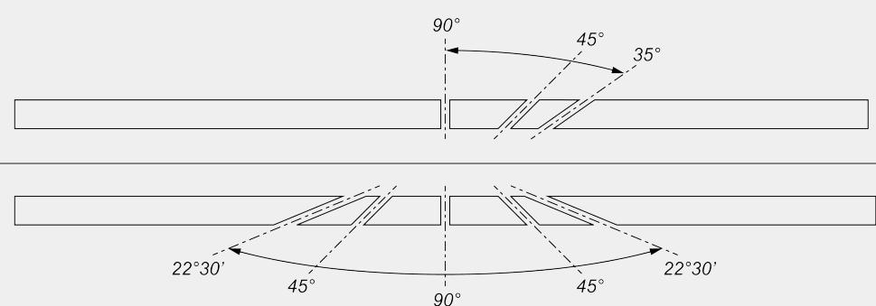
Réglage électronique des angles intermédiaires sur axe vertical
