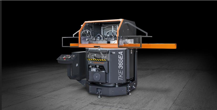
Tronçonneuse simple tête à lame ascendante avec rotation automatique à commande numérique de l'axe vertical au moyen d'un moteur brushless et pivotement simultané de l'axe horizontal par commande hydraulique. Angles de coupe de 90° à 22°30' (gauche et droite) sur l'axe vertical et de 90° à 35° (uniquement à droite) sur l'axe horizontal.
