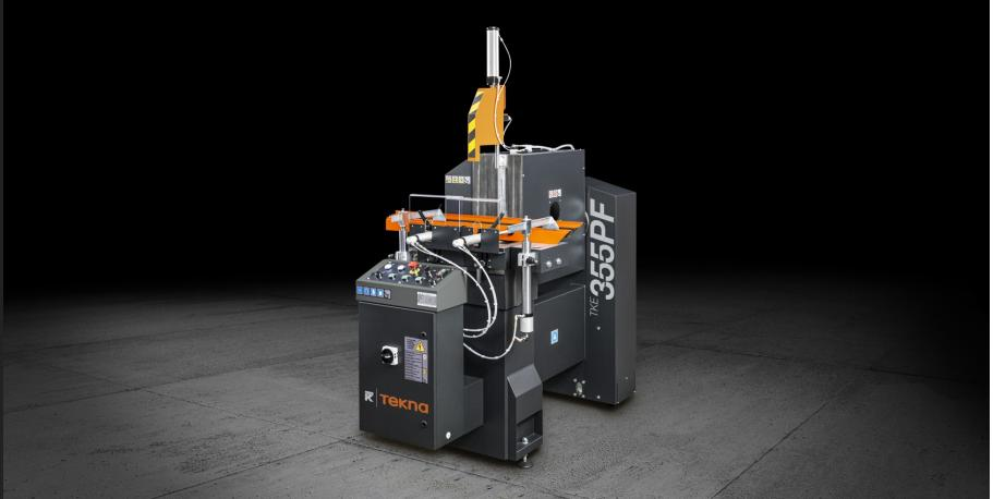
Tronçonneuse simple tête à lame frontale, côté de chargement sur la gauche et double pivotement latéral à commande pneumatique en positions fixes : 45° gauche et 90°, 45° et 22°30' droite. Une butée mécanique spécifique assure également la coupe à des angles intermédiaires.
