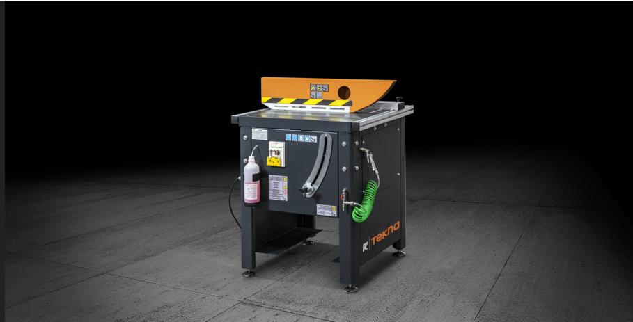
Délineuse simple tête à lame ascendante pour profilés extrudés et tôles d'aluminium plates. Sa structure particulièrement robuste permet d'obtenir une coupe précise et nette qui assure un parfait parallélisme aux faces des profilés. Elle est également conçue pour recevoir des chemin d'aménage qui augmentent son caractère polyvalent. Le carter de protection de la lame a été pensé et réalisé pour travailler dans les meilleures conditions de sécurité possibles.
