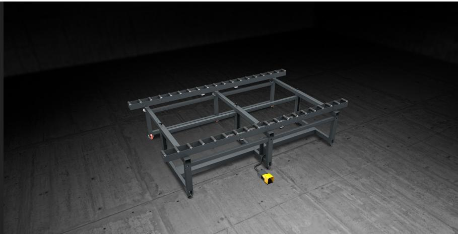
Table modulaire de grandes dimensions conçue pour le montage et la manutention en ligne de cadres de murs-rideaux. Equipée de deux chemins d'amenage recouverts d'une gaine en PVC souple; le réglage de la distance entre les deux chemins d'amenage est fonction de la largeur de la pièce. Un système à actionnement pneumatique permet de bloquer les rouleaux durant les phases de travail.
