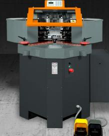
La machine dispose de deux têtes d'usinage spéciales équipées de masses dans lesquelles les 2 couteaux sont réglables dans toutes les positions de sertissage. Les couteaux se déplacent et sont réglables sur l'axe Y (le long du profilé), sur l'axe Z (haut-bas) et sur l'axe X (dans le sens du sertissage). Ces conditions permettent d'éviter le remplacement des outils sur la machine indépendamment des différents types de profilés. Cela réduit les temps et les coûts de mise en place.
