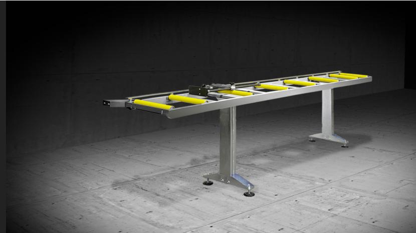
Construcción de acero tubular con patas de montaje ajustables y rollos de acero cubiertos de PVC. En la versión con rollo de 240 mm, la longitud del transportador de rodillos es de 3.500 mm; con rollos de 440 mm, la longitud del transportador de rodillos es de 4.000 mm.
