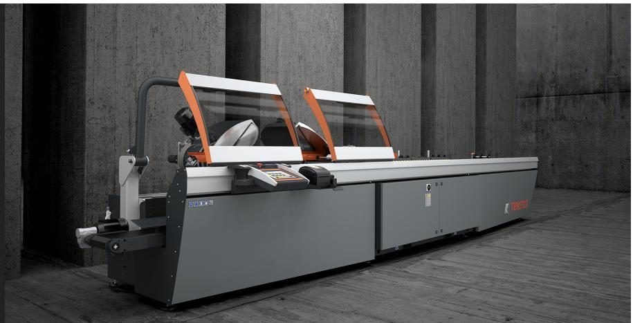
Tronzadora de doble cabezal de 3 ejes controlados con movimiento automático del cabezal móvil y gestión electrónica de todas las angulaciones de 45° (internos) a 15° (externos) con una precisión, en el ámbito de cada grado, de 280 posiciones. El avance del disco es accionado por dos cilindros oleoneumáticos.
