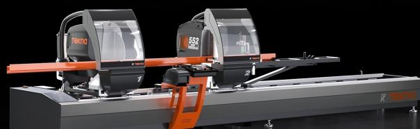
Tronzadora de doble cabezal electrónica con movimiento automático del cabezal móvil mediante motor brushless accionado por un control numérico. Inclinación neumática de los cabezales de corte de 90° hasta 22°30' (externa) en dos posiciones fijas o con sistema opcional mecánico de regulación de los ángulos intermedios. Avance disco oleoneumático.
