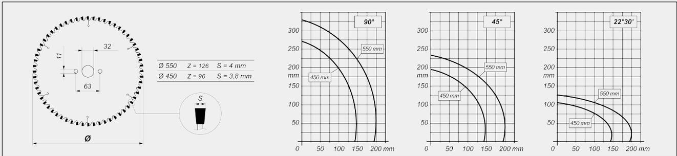
**INCLINACIÓN CABEZAL DE CORTE**
