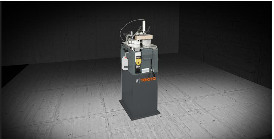
Tronzadora monocabezal ascendente para efectuar cortes a 90°, 45° (a la derecha y a la izquierda) y en angulaciones intermedias.
