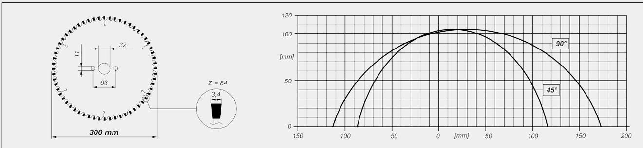
**INCLINACIÓN CABEZAL DE CORTE**
