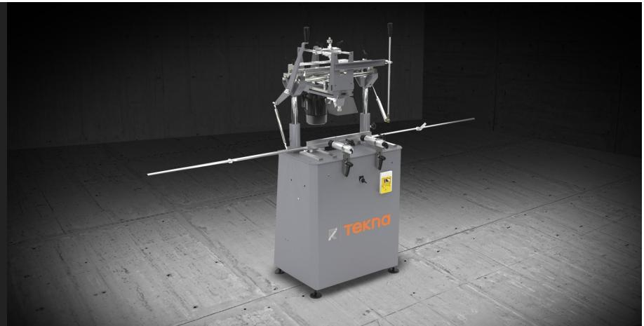
TKE 151 S es una fresadora copiadora de una unidad de fresado con bajada manual, amplia carrera en altura y traslación de la unidad por medio de palanca indirecta. Posibilidad de realizar mecanizados pasantes sin girar la pieza. Palpador de mando manual.
