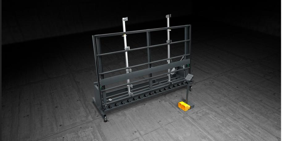
Banco de pruebas para cerramientos de aluminio. Permite recrear las condiciones de uso del producto: se bloquea el marco mediante un sistema de mordazas ajustables en toda su altura, se introducen las hojas en el interior del marco, se instala el vidrio y se realizan las pruebas finales. El transportador de rodillos permite al operador cargar y descargar los productos pesados con total autonomía.
