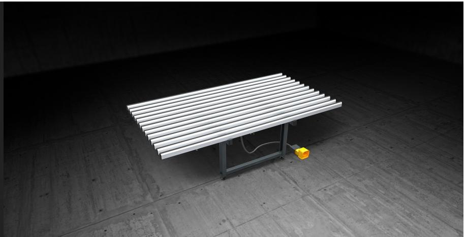
Banco para ensamblar hojas y marcos. Banco horizontal con intercambio neumático entre el plano de apoyo de PVC blando (para la fase de montaje) y el plano de apoyo de PVC rígido antifricción (para la fase de manipulación). Se puede regular la altura del plano de apoyo de 895 a 965 mm y sus pies tienen agujeros para poder fijarse al suelo.
