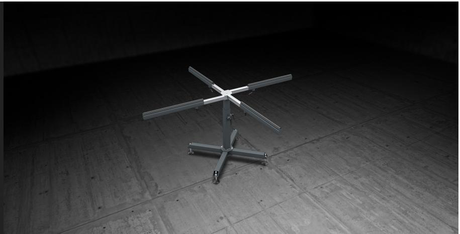
Banco para ensamblar accesorios y juntas de goma. Gira sobre un eje central y puede alargarse. Permite girar el marco.
