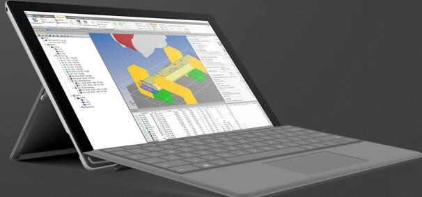
Es el software que permite importar formatos “STEP” y “ACIS-SAT” de programas CAD-3D como Autodesk Inventor, Solidworks, etc. Es posible cargar tanto piezas individuales como conjuntos de piezas. Mediante procedimientos guiados reconoce automáticamente los mecanizados. Con DriverCAD se reducen los tiempos de introducción de los mecanizados y, por consiguiente, disminuyen las posibilidades de cometer errores.
