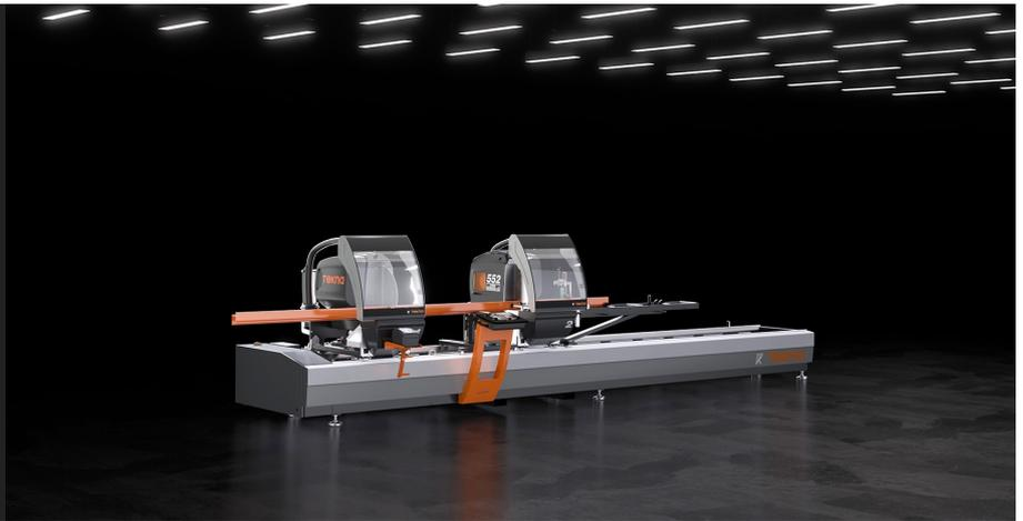
Elektronische Doppelgehrungssäge mit mittels NC-gesteuertem Brushless-Motor automatisch verfahrbarem Sägeaggregat. Pneumatisch gesteuerte Neigung der Sägeaggregate von 90° auf 22°30' (nach außen) auf zwei festen Positionen oder mit einem optionalen mechanischem Einstellsystem der Zwischenwinkel. Hydropneumatischer Sägeblattvorschub.
