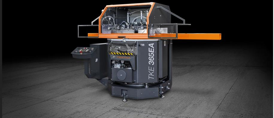
Schifterschnittsäge mit von unten kommendem Sägeblatt und automatischer CNC-gesteuerter Drehung um die vertikale Achse über Gleichstrommotor mit gleichzeitiger hydraulischer Drehung um die horizontale Achse. Gehrungsschnitte von 90° bis 22°30' (links und rechts) auf der vertikalen Achse und von 90° bis 35° (nur rechts) auf der horizontalen Achse (nur rechts).
