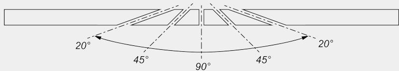
Mechanische Einstellung der Zwischenwinkel
