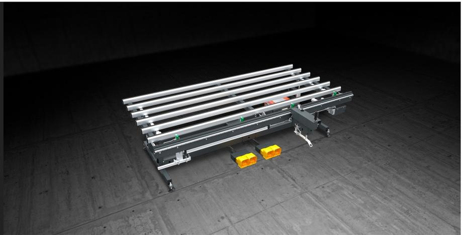
Arbeitstisch für die Montage von Bandbeschlägen an Flügeln aus Aluminium, Holz und PVC. Ein versenkbares Spannsystem sorgt für die Einspannung des Flügels. Der Arbeitstisch ist mit einem Anschraubsystem mit Selbstspeisung sowie, als Optional, mit einem System für die Messung und den Schnitt der Beschläge mit einer hydropneumatischen Schere ausgestattet.
