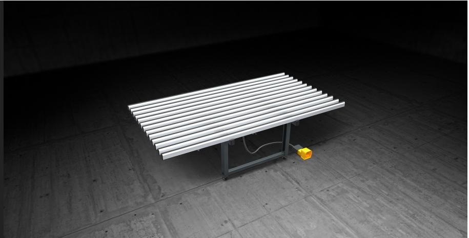
Montagetisch für alle Montagearbeiten von Flügeln und Rahmen. Horizontaler Arbeitstisch mit pneumatischem Wechsel zwischen einer Ablageplatte aus weichem PVC (für die Bearbeitungsphase) und einer Ablageplatte aus kratzfesten hartem PVC (für die Handlingphase). Arbeitstisch höhenverstellbar von 895 mm bis 965 mm. Füße mit Löchern zu Verankerung am Boden.
