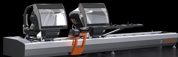
Tronçonneuse double tête à 3 axes contrôlés avec mouvement automatique de la tête mobile et gestion électronique de tous les angles dans la plage 22°30' externes et 45° internes. L'avancement des deux lames de 550 mm est assuré par des cylindres oléo-pneumatiques.
