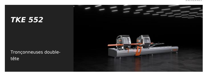
Tronçonneuse à double tête électronique, mouvement automatique de la tête mobile grâce à un moteur brushless à commande numérique par calculateur. Inclinaison pneumatique des unités de coupe de 90° jusqu'à 22°30' (externe) dans deux positions fixes ou avec système mécanique optionnel de réglage des angles intermédiaires. Avance oléopneumatique de la lame.
