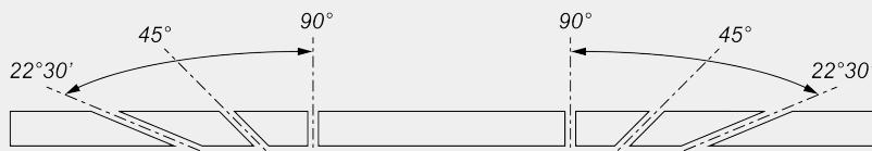
Réglage mécanique des angles intermédiaires
